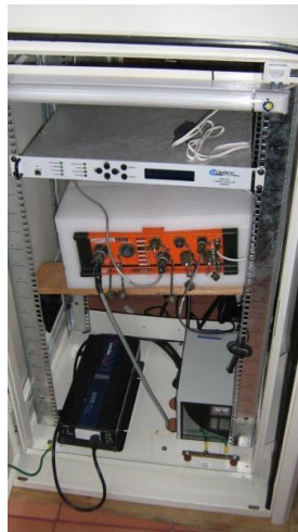
Figura 59. Vista externa (izquierda) de la caseta de la estación sismológica ubicada en Yotoco, Valle. Ubicación del digitalizador y acelerómetro dentro de la caseta (derecha).
