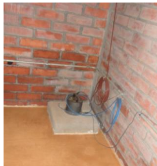
Figura 58. Vista externa (izquierda) de la caseta de la estación sismológica ubicada en Tame, Arauca. Ubicación del acelerógrafo dentro de la caseta (derecha).
