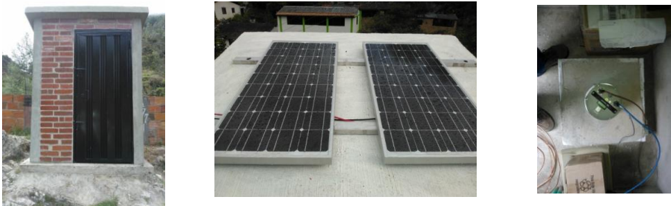
Figura 56. Vista externa (izquierda) y superior (centro) de la caseta de la estación de acelerógrafos ubicada en Pamplona (barrio Zulia. Ubicación del acelerógrafo dentro de la caseta (derecha).
